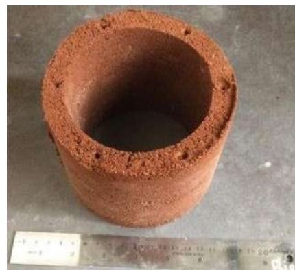
Gambar 4. Exothermic sleeve dengan bahan dasar aluminium dross.
